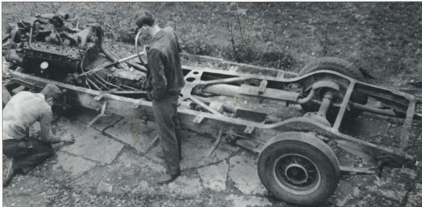
Bilden ger en god uppfattning om chassiets och motorns väl tilltagna dimensioner hos en Packard 1408, som var 1936 års största chassityp. (Foto från Olof Ulander.)
